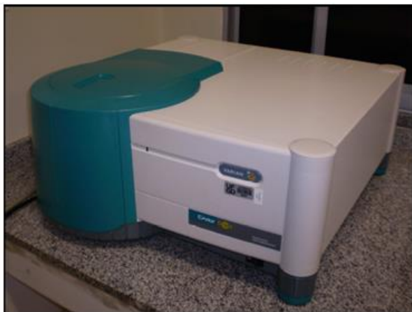
Figura 4.5. Espectrofotômetro de fluorescência utilizado nas medidas de fluorescência das amostras dopadas com óxido de disprósio ( Dy_2O_3 ).
