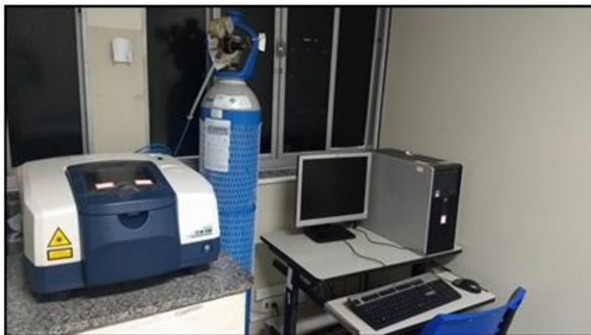
Figura 4.3. Espectrofotômetro modelo FTIR 4100 (Jasco). Equipamento utilizado na obtenção dos espectros de absorção das amostras vítreas na região do infravermelho.
